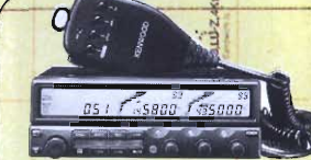
TM-742 E - Veicolare multibanda 144 e 430 MHz più una terza (28-50MHz-1.2 GHz)
