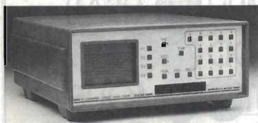
Analizzatore logico 32 canali 3332 - £ 1.015.000
